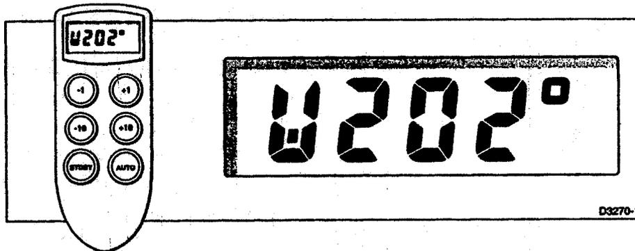
Se il display continua a mostrare la rotta attuale preceduta da una "C" lampeggiante, questo significa che i dati del vento non sono ricevuti dall'autopilota.
