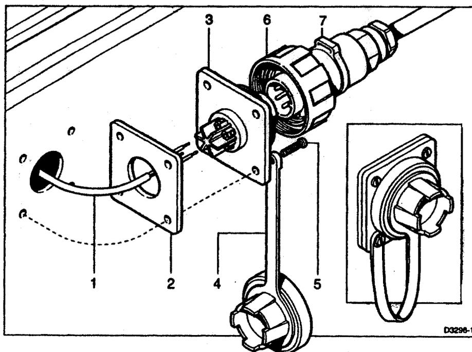
1 Cavo, 2 Guarnizione, 3 Presa, 4 Coperchio in gomma, 5 Viti, 6 Connettore, 7 Anello di tenuta
