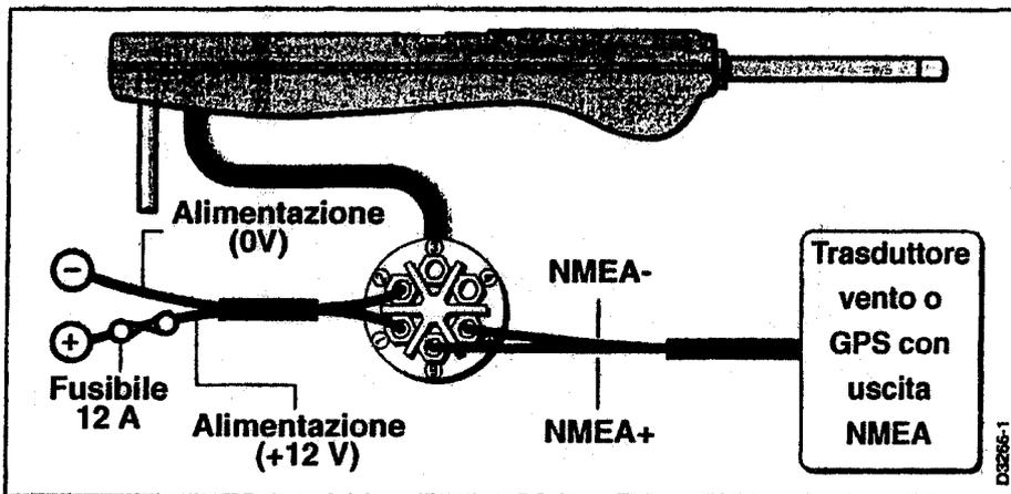
**Cablaggio per la trasmissione dati NMEA e SeaTalk**
